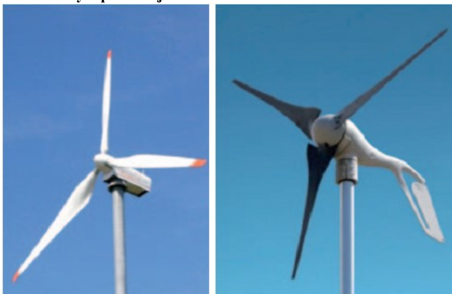
Rysunek 4. Turbiny o poziomej osi obrotu
